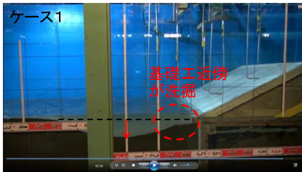
写真-3 越流後の地形（ケース 1）
