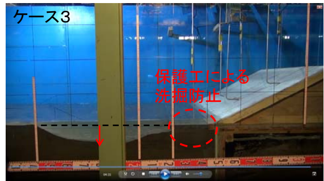
写真-4 越流後の地形（ケース 3）
