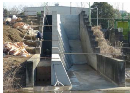
写真-2 高落差実験水路(縮尺 1/2)
